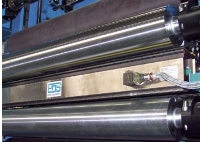
Pinhole-Detektor zur Erkennung kleinster Löcher im \mu -Bereich
