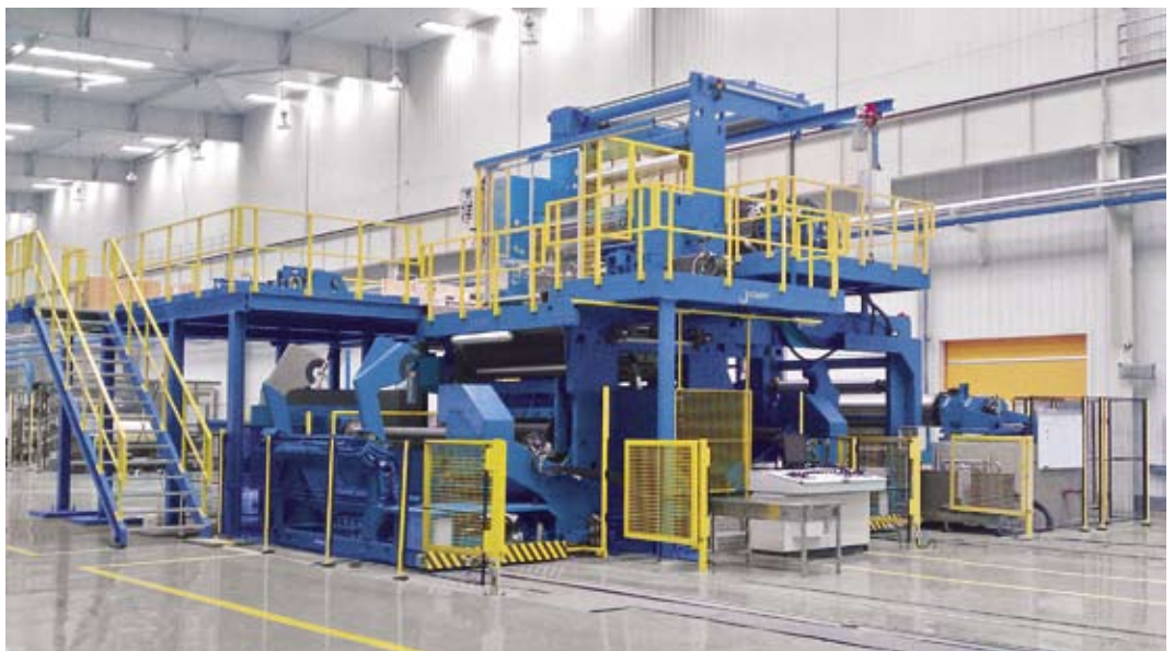
Schneidmaschine Centurial für Applikationen mit geringeren Fertigrollendurchmessern Centurial slitting machine for applications with smaller rewind diameters
