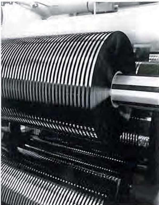
Abb. 2: Dünnscheibe Kondensatorfolien – schmale Schnitte Fig. 2: Thinnest capacitor films - narrow cuts
