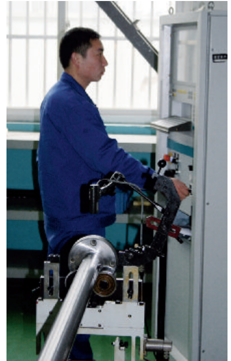
Direkt vor Ort werden die High-tech- Walzen ausgewuchtet
